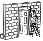
Introduzca la mezcla por la parte superior y por los costados del marco como lo indica el gráfico. Limpiar del marco exterior el exceso de mezcla que pueda filtrarse
