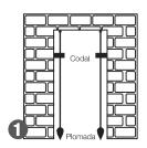
Antes de instalar la puerta, verifique que ambos lados del vano estén totalmente paralelos y verticales.
