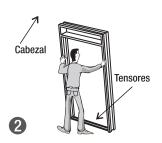
Retirar los tensores y llevar la nave ensamblada hacia el vano.
