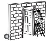
Introduzca la mezcla por la parte superior y por los costados del marco como lo indica el gráfico. Limpiar del marco exterior el exceso de mezcla que pueda filtrarse
